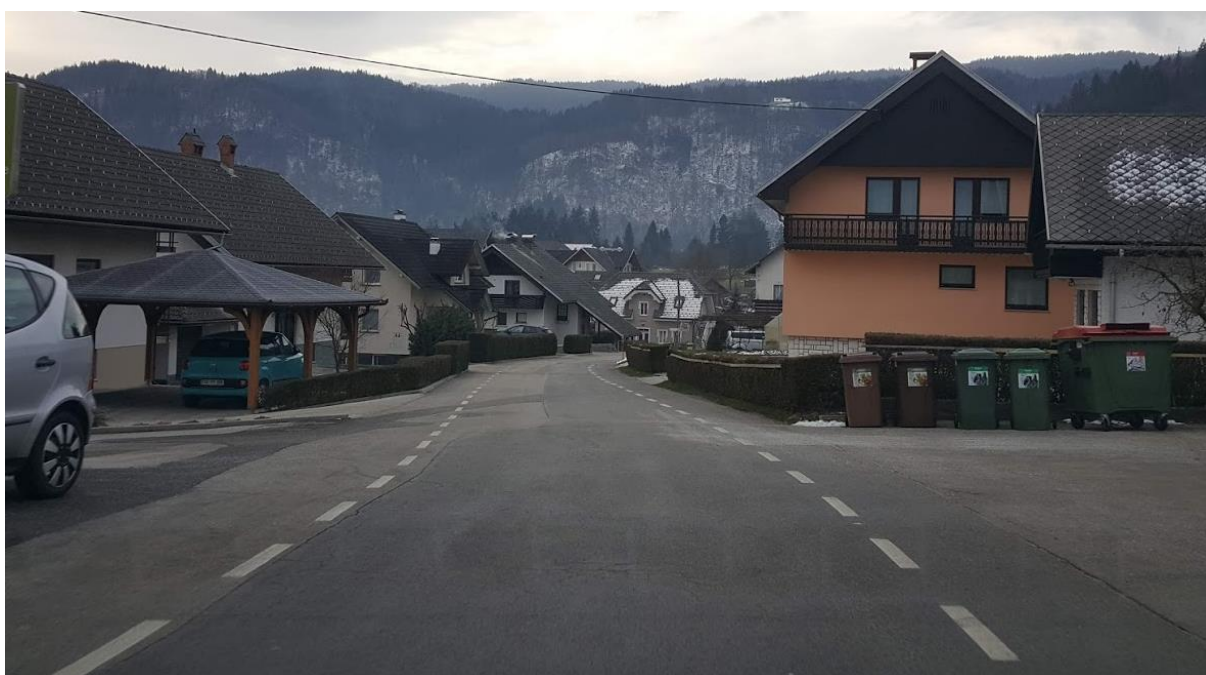
Slika 50: Najbolj prometno obremenjena ulica v Ribnem (Izletniška ulica) ima označene pomožne pasove za pešce in kolesarje. Kolesarji vozijo po desnem robu, pešci hodijo po levi strani.
